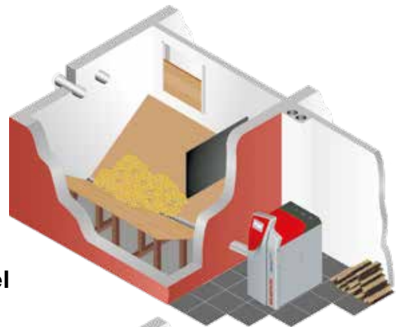
Pelletbox 350 liter handmatig vulbaar met zuigsonde
